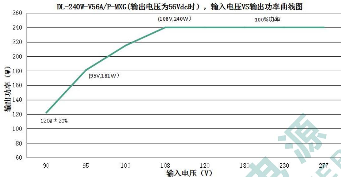
DL-240W-V56A/P-MXG(输出电压为 56Vdc 时，不同输入电压对应的额定输出电流值和输出功率)
