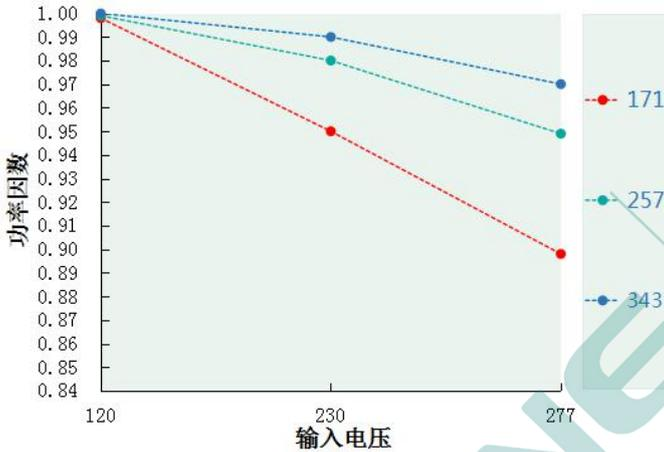
功率因素 VS 输入电压 DL-240W-V56A/P-MXG
