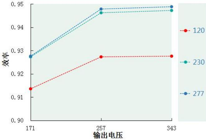
效率 VS 输出电压 DL-240W-V56A/P-MXG
